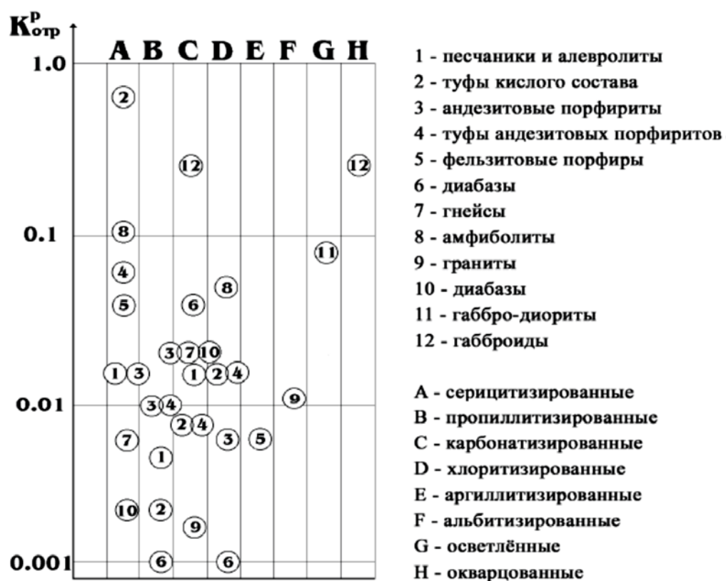
Рисунок 1.8 – Значения коэффициентов отражения продольных волн для пород, подвергнувшихся гидротермально-метасоматическим изменениям (Кузин А.М., 2008)
